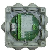
**MAY1 Module interface à zone adressable pour points conventionnels** : Occupe une adresse de point. La ligne conventionnelle secondaire gère un maximum de 32 éléments. Nécessite une alimentation externe (24V/0,02A surveillé). Sortie collecteur ouvert répétition d'alarme.
