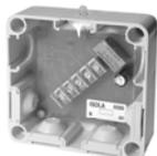
**ISO95 Module isolateur de boucle** : Permet l'isolation des sections en court-circuit localisées entre deux modules ISO95. Pour des lignes connectées en boucle, 1 module ISO95 tous les 32 points, n'occupe pas d'adresse, un LED d'avertissement de couleur jaune indique l'ouverture de l'isolateur.
