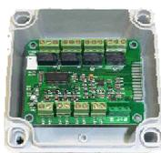
**FM2IO, FM4I, FM4IO Modules 2 entrées/2 sorties, 4 entrées, 4 entrées/4 sorties** : Module de max. 4 entrées surveillées lisant des informations de dérangement et d'alarme à l'aide de circuits d'entrée spécifiques. L'activation et la désactivation des relais sont opérées par des commandes envoyées par la centrale aux adresses concernées. Max. 4 relais programmables (contact libre de potentiel). 1 adresse pour chaque direction entrée/sortie. Alimentation par boucle.
