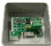
**ATG95 Module d'entrée pour détecteurs de gaz** : 1 adresse pour préalarme et 1 adresse pour alarme. 1 entrée unique surveillée. ATG95 envoie des informations à la centrale en fonction de la valeur de résistance sur la ligne d'entrée.
