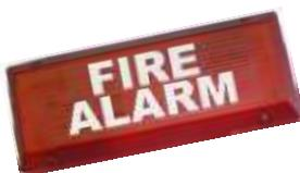
**P7264/66** pannello ottico acustico ad alto assorbimento ( 150 mA) con led ad alta illuminescenza , dotato di sirena , grado di protezione IP54, alimentazione 24 V. Disponibile anche in versione autoalimentata con batterie Ni-Cd con il codice P7266. Potenza sonora : 100 dB
