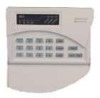
**DA4:** Combinatore telefonico a 4 ingressi e 4 messaggi vocali. Può lavorare come accessorio controllato da una centrale o da solo con rilevatore collegato direttamente all'ingresso. 1 messaggio vocale della durata di 10 sec max.. attivato tramite segnale a 24V o 0V. Memorizzazione sicura del messaggio nella EEPROM memoria non volatile. Circuiti optoelettronici, uscite relè e open collector per l'interfacciamento con le unità esterne.
