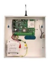
**GSM 31 GPRS:** Combinatore GSM/GPRS (con custodia metallica, antenna GSM e alimentatore). Può lavorare come accessorio controllato da una centrale o da solo come unità di allarme. Può essere usato come backup di linea telefonica in caso di guasto. Necessita di SIM card. Consente di trasferire informazioni generali dalla central per mezzo di messaggi GSM/GPRS (SMS).
