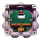
**MAY1Ex module interface à zone adressable pour points à sécurité intrinsèque** : Occupe une adresse de point, gère max. 6 éléments à sécurité intrinsèque. Nécessite une alimentation externe (24V/0,02A surveillé). Sortie collecteur ouvert.
