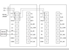
Raccordement électrique de la version relais ; alimentation par ligne DI. EFL est l'élément de fin de ligne, RAL est la résistance d'alarme Electric connection of the relay version; Power supply by detection line EFL is the end of line element; RAL is the alarm resistor.
