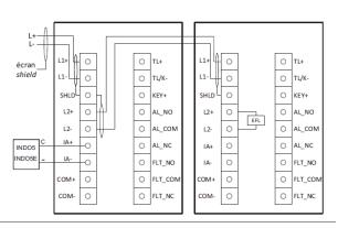
Raccordement de la ligne ouverte (version adressable) Connection for the line (addressable version)
